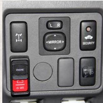
◀ **Not-Aus:** Links unten im Armaturenbrett findet sich der Hauptschalter, der den Strom für die Seilwinde kappen kann.
