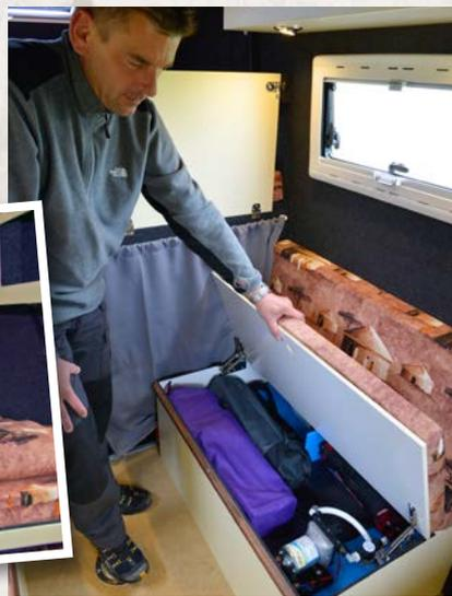
▲ **Abseits der Zivilisation autark:** Unter der Bank steckt die Wasseraufbereitungsanlage.
