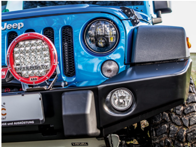
Clever gelöst: Die Zusatzscheinwerfer auf der Stoßstange können über die Fernbedienung der Seilwinde geschaltet werden.
