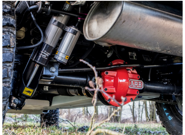
Robust: Der Differential-Schutzdeckel von ARB erhöht die Verwindungssteifigkeit der Achse und verfügt über einen integrierten Ölpeilstab.
