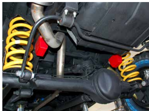
▲ Hart im Nehmen: Das TJM-Fahrwerk ist auf das erhöhte Fahrzeuggewicht abgestimmt.
