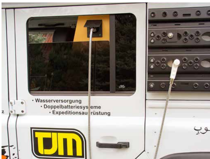
▲ Frage der Hygiene: Die Außendusche wird per Schnellverschluss angeschlossen. Sie wird über den 75-Liter-Tank gespeist.
