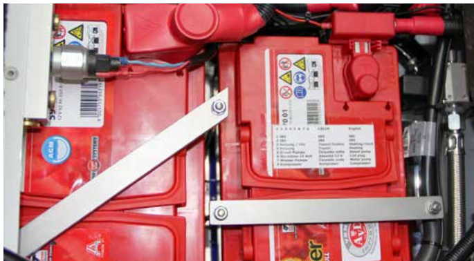
▲ Genug Saft: Starter- und Verbraucherbatterie werden durch das IBS-Relais getrennt.
