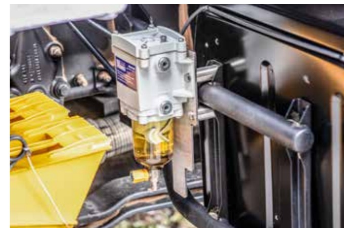
Auf Nummer sicher: Frank installierte einen Diesel-Vorfilter mit Wasserabscheider – gut für Regionen mit schlechter Spritqualität.
