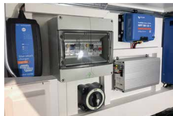
Hightech-Zentrale: Gut erreichbar platzierte Frank Sicherungskasten, Solarregler und das Ladesystem zur Stromversorgung.
