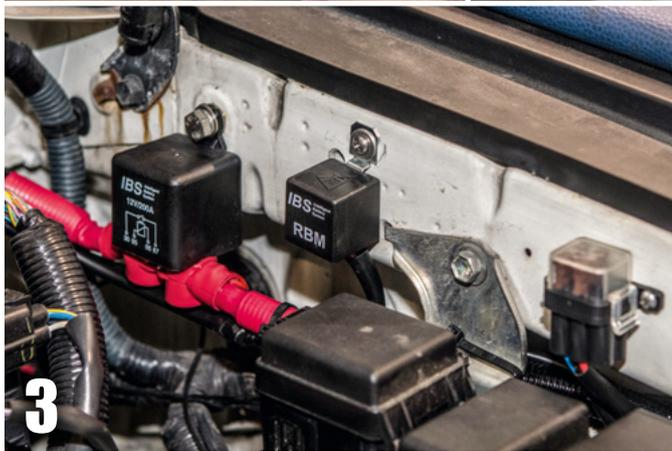
**Schritt für Schritt:** Alle Verbindungen an den Kabelenden werden mit Schrumpfschlauch geschützt (1). An den Massepunkten muss für ausreichend Kontakt gesorgt werden, anschließend wird gefettet (2). Die Trennrelais von IBS werden im Motorraum montiert. Sie stellen den Stromfluss zur Zweitbatterie her (3).
