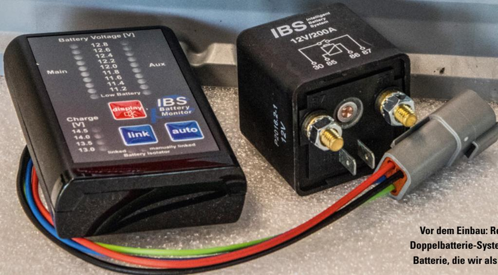
Vor dem Einbau: Relais und Monitor des IBS-Doppelbatterie-Systems und die AGM-Panther-Batterie, die wir als Zweitbatterie verwenden.
