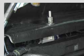
Ohne Bohren: Das Hardtop wird mit Klammern befestigt.
