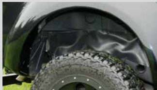
Geschlossen: Eine Abdeckung im Radhaus schützt vor Schmutz.
