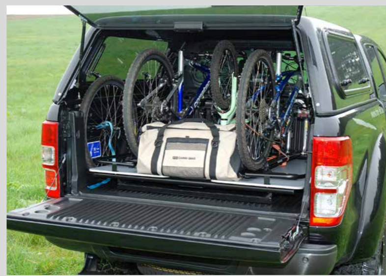
Ordentlich verstaut: Der ausziehbare Ladeboden erleichtert das Einladen von Fahrrad und Gepäck deutlich. Die Schienen können demontiert werden.
