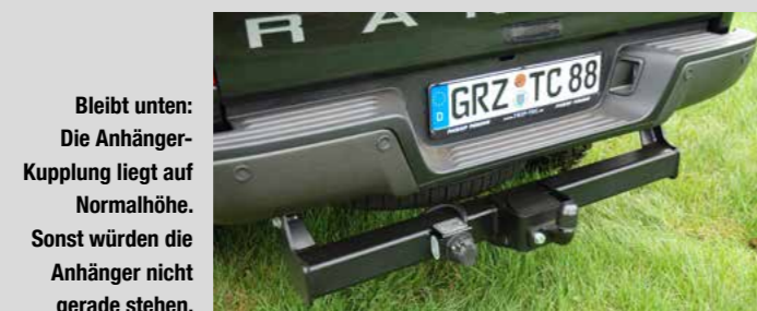
Umgesetzt: Die Stoßstangen wandern mit der Karosserie nach oben.
