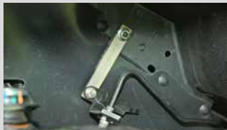
Notwendig: Beim Einbau des Bodylifts werden die Bremsleitungen versetzt.
