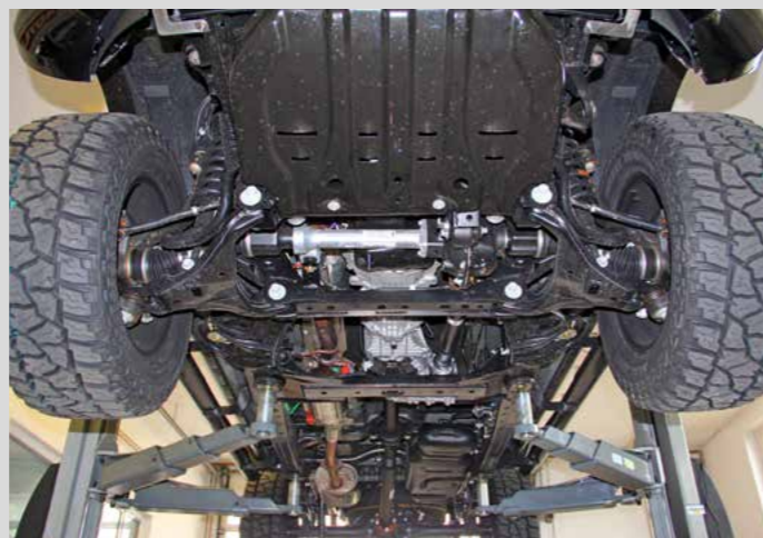
Aufwändig: Der Einbau des Bodylifts ist kein Kinderspiel. Am Ranger müssen zahlreiche kleine Änderungen vorgenommen werden.
