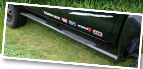
Volle Breitseite: Reifen und Bodylift heben den Ranger um mehr als 12 Zentimeter an. Die Schweller-Rohre liegen geschützt oberhalb des Leiterrahmens.
