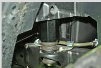
Distanzstücke: Zehn Zentimeter hohe Blöcke heben die Karosserie an.
